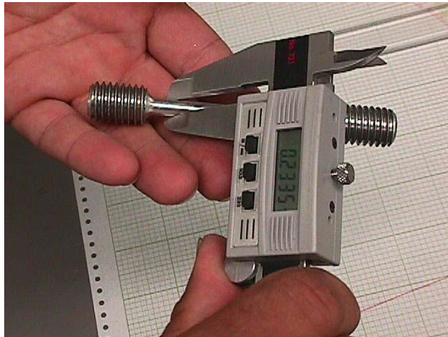
Merenje prečnika epruvete pre zatezanja
