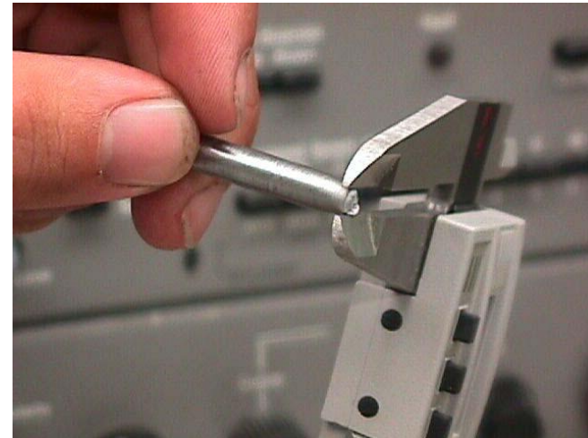
Merenje prečnika epruvete na mestu prekida
